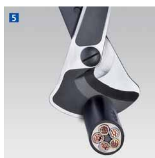
Opakujte řez a rozevření, až je kabel přeštipnutý.
