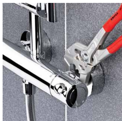
Práce s chromovanými armaturami bez poškození povrchu
