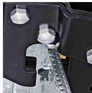
Lisovací nástroj je stlačován profilovanými plechy
