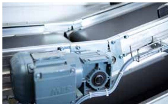
Šrouby ecosyn®-grip u pásového dopravníku
